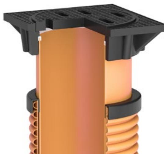
Герметичность соединения телескопа с телом колодца обеспечивается специальным резиновым адаптером, который также компенсирует возможные вертикальные перемещения телескопа относительно неподвижного тела колодца, связанные с повышенной дорожной нагрузкой, сезонными и прочими колебаниями грунта и дорожного покрытия, допуская отклонения телескопа.
